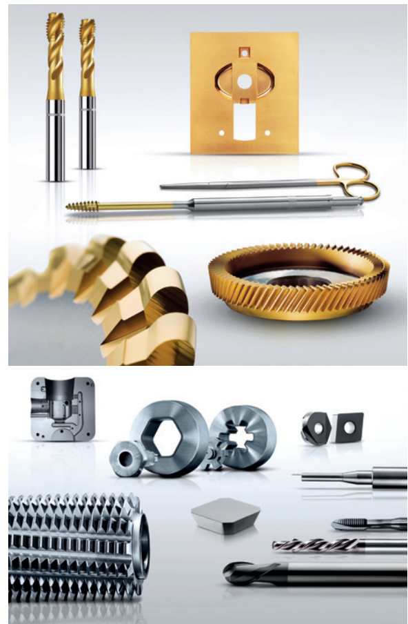
Bild 7: Werkzeuge beschichtet mit BALINIT® A (TiN, oben) und BALINIT® ALCRONA PRO (AlCrN, unten)
